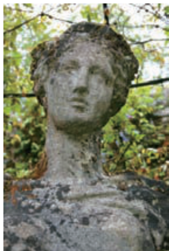
▲ FIGURA 5.10 Daños causados por la lluvia ácida La lluvia ácida ha erosionado esta estatua de mármol. El mármol es un material que tiene \text{CaCO}_3 como principal componente. Los ácidos reaccionan con el mármol disolviéndolo por medio de la reacción descrita por la Ecuación (5.14).
