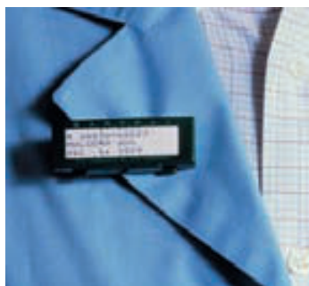
▲ Tarjeta de identificación utilizada para detectar la radiación.
