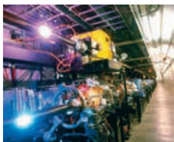
▲ Centro del Acelerador Lineal de Stanford (dispositivo de colisiones SLAC0 PEP-II). Los electrones (azul) y los positrones (rosa) circulan en sentidos opuestos a lo largo de dos anillos antes de ser forzados a colisionar. Estas colisiones producen grandes cantidades de partículas subatómicas (p. ej., «mesones \beta y anti-mesones \beta »).
