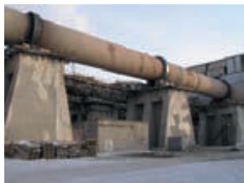
▲ La descomposición (calcinación) de la caliza se lleva a cabo en un horno rotatorio alargado, ya sea para producir cal viva, \text{CaO} , o cemento Portland.
