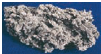
▲ Esponja de titanio metálico, destilado a vacío, producido en el proceso Kroll.
