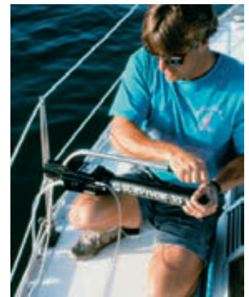
▲ Una pequeña unidad de ósmosis inversa para desalinizar agua de mar.
