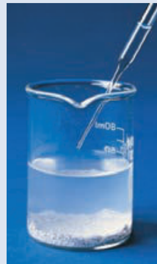
▲ FIGURA 18.6 Reprecipitación del \text{AgCl}(\text{s}) Se añade \text{HNO}_3(\text{aq}) como reactivo, a la disolución que contiene [\text{Ag}(\text{NH}_3)_2]^+ y \text{Cl}^- . El ion \text{H}_3\text{O}^+ del ácido reacciona con el \text{NH}_3(\text{aq}) para formar \text{NH}_4^+(\text{aq}) . Esto modifica el equilibrio entre [\text{Ag}(\text{NH}_3)_2]^+ , \text{Ag}^+ y \text{NH}_3 . El ion complejo se destruye, [\text{Ag}^+] aumenta rápidamente hasta que se supera K_{\text{sp}} del \text{AgCl} y se forma un precipitado.
