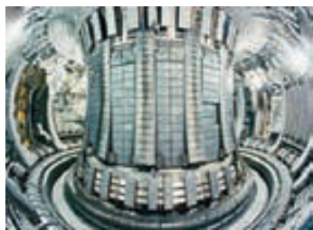
▲ La cámara de plasma de un reactor de fusión de confinamiento magnético (denominado un tokamak ). Los muros de la cámara están revestidos con baldosas de agregados de fibra de carbono para protegerlos de las elevadas temperaturas del plasma.
