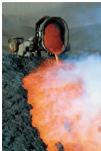
▲ Escoria formada durante la fundición del mineral de cobre.
