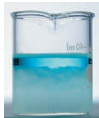
▲ FIGURA 13.9 Recristalización de \text{KNO}_3 Cristales incoloros de \text{KNO}_3 procedentes de una disolución acuosa de \text{KNO}_3 y \text{CuSO}_4 (como impureza). El color azul pálido de la disolución se produce por los iones \text{Cu}^{2+} , que permanecen en disolución.
