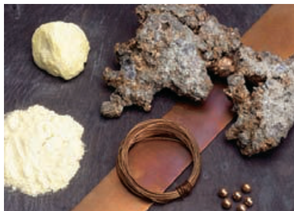
► FIGURA 1.2 Propiedades físicas del azufre y del cobre. Una piedra de azufre (izquierda) se deshace en un polvo amarillo si se le da con un martillo. El cobre (derecha) se puede encontrar en grandes pepitas de cobre nativo que martilleando se puede convertir en una lámina delgada o estirar en un hilo.
