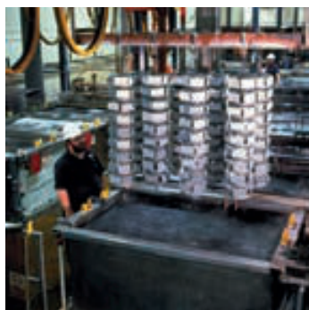
▲ Después del depósito electrolítico, un conjunto de piezas metálicas son extraídas de una disolución de electrolito.
