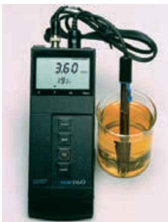
▲ FIGURA 16.13 Propiedades ácidas de los iones metálicos hidratados El color amarillo del indicador azul de bromotimol en una disolución de \text{Al}_2(\text{SO}_4)_3(\text{aq}) indica que la disolución es ácida. El pH-metro da una medida más precisa del pH.
