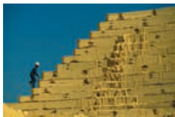
▲ Estas grandes extensiones de azufre sólido se han formado por solidificación de azufre líquido obtenido por el proceso Frasch.
